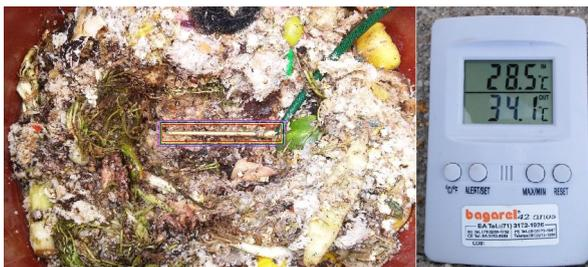
**Figura 4:** Vista geral do sensor de temperatura e do leitor externo.
