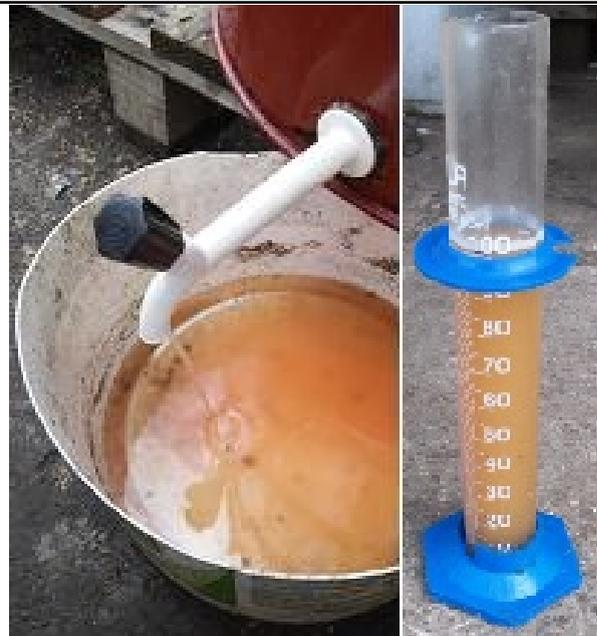
**Figura 5:** Vista do sistema montado para coleta e medição do lixiviado.
