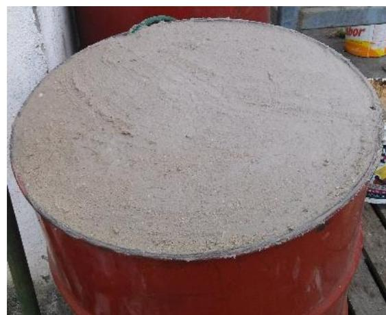
**Figura 6:** Vista da camada de cobertura realizada sobre o lisímetro.
