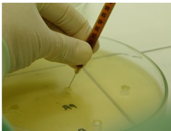
Figura 4: Preenchimento dos poços, com identificação. Fonte: Autores (2005).
