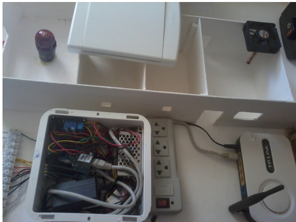
Figura 10: Quadro de Distribuição com o Arduino, suas fontes de alimentação e distribuição dos circuitos para a casa. Fonte: autor.
