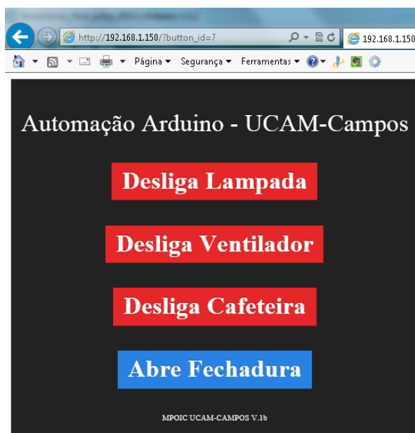
Figura 16: Interface da aplicação web com suas respectivas funções. Fonte: autor.
