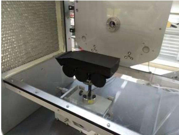
Figura 9: Fotografia do modelo impresso no interior do túnel de vento.
