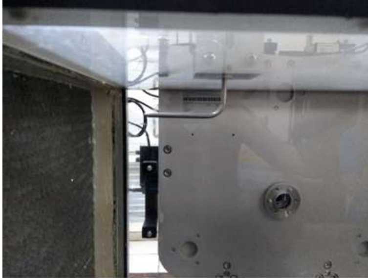
Figura 11: Fotografia do tubo de Pitot utilizado no experimento.
