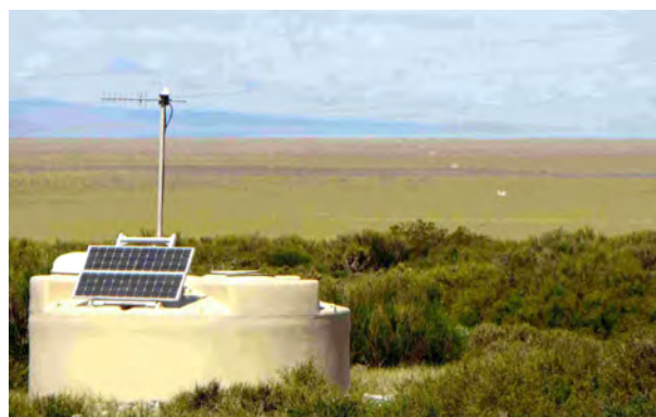
Figura 4: Foto de um detector Auger SD e uma linha de detectores separados por 1.5 km
