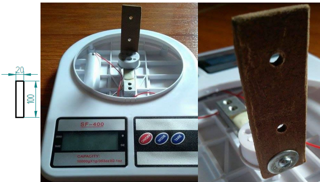
Figura 8 - Força de sustentação - montagem. Fonte: Próprio autor, 2017.
