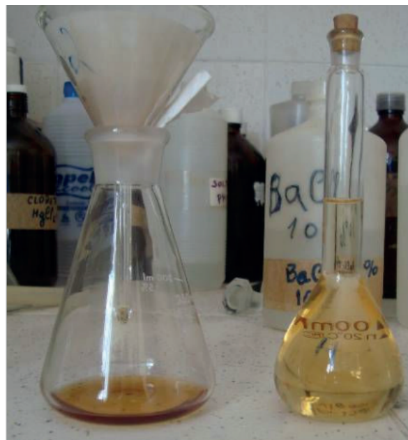
Figura 6: Comparativo entre solução padrão e a mistura areia vermelha + solução. Fonte: Osair (2009).
