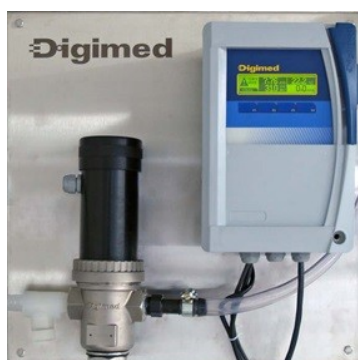
Figura 15: Analisador de cloro. Fonte: DIGIMED (2011).
