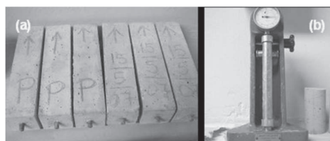
Figura 2 : (a) Corpos-de-prova identificados e armazenados em câmara seca de temperatura controlada. (b) Aparelho de medição da retração – Unidade: 1/100mm.
