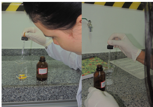
Figura 4: Reação de precipitação. Amostra 1 – positivo para chumbo. Amostra 2 – positivo para bário
