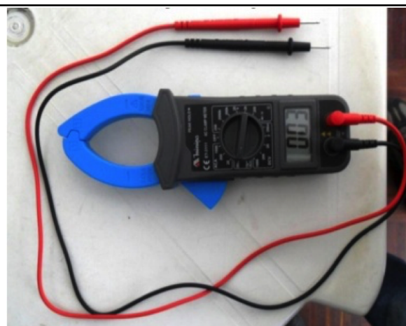
Figura 5: Alicete amperímetro digital utilizado para medição da corrente elétrica e tensão elétrica do aerogerador
