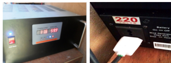
Figura 3: Inversor de frequência utilizado no trabalho (A) e a tensão de saída (B)
