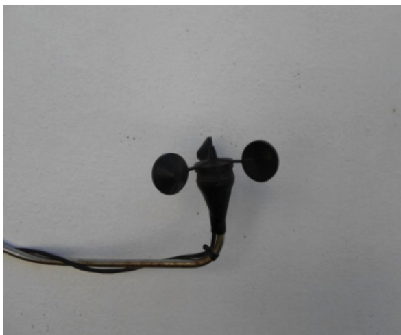
Figura 1: Anemômetro de conchas utilizado para medição da velocidade do vento
