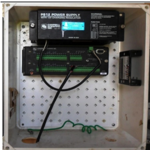
Figura 4: Datalogger utilizado para armazenamento dos dados no experimento
