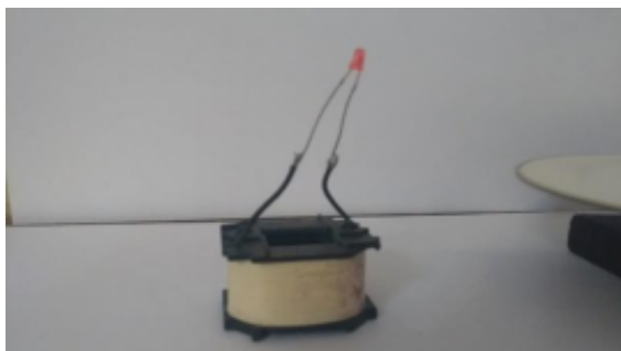
Figura 4: LED ligado aos terminais da bobina.
